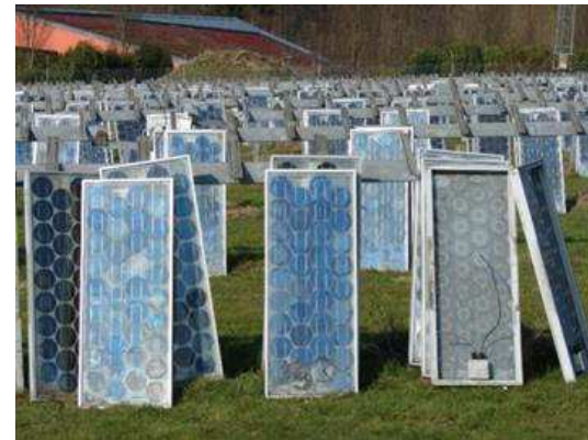
Figure 84 : Panneaux photovoltaïques en fin de vie (source : Soren, 2015)
