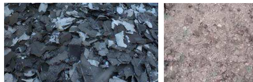
Figure 86 : Fragments de silicium et granulés de verre (source : Soren, 2015)
